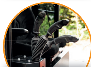
Commande par joystick : Fonctions de préhension et levage/abaissement
