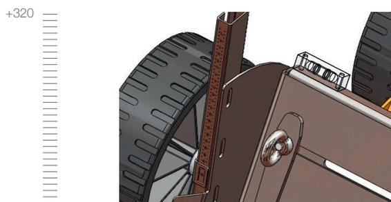
Indication des dimensions (hauteur des roues) de -40 à +320 mm
