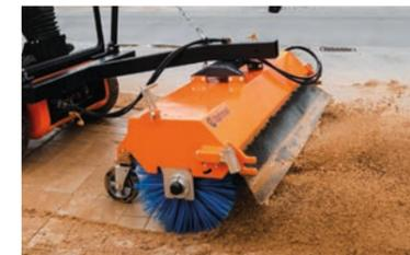
Die Kehrmaschine wird einfach und schnell an die Vorderachse montiert. Einfache mechanische Schrägstellung um 20° nach rechts und links. Bei Bedarf kann das abgefegte Material gleichzeitig in einem Sammelbehälter (optional) aufgefangen werden. Ideal zum Kehren (Reinigen) von Baustellen und Hofflächen.
