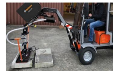
Mit dem Vakuumgerät können Beton- und Natursteinelemente alleine durch den Fahrer vom Paket aufgenommen und direkt an der gewünschten Position abgesetzt werden. Durch Montage unterschiedlicher Ansaugplatten kann das Vakuum-Anbaugerät zum Setzen von Beton- u. Natursteinplatten/-elementen genutzt werden.
