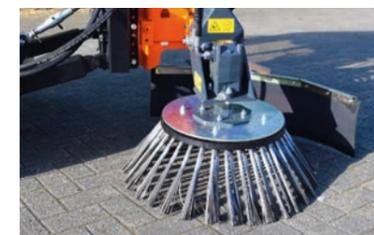
Mit der hydraulisch angetriebenen Wildkrautbürste entfernen Sie absolut mühelos und chemiefrei jegliche Art von Wildkräutern. Als Anbaugerät für die Optimas Pflasterverlegemaschine stellt die Wildkrautbürste ein optimales Reinigungssystem zur Beseitigung von hartnäckigem Schmutz auch in Randbereichen dar.
