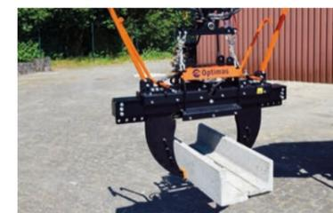
Der Steingreifer Multiflex eignet sich zum Setzen von Beton- und Granitbordsteinen, Rinnensteinen, Blockstufen und div. Platten. Durch Austausch der Greifbacken (optional) ergeben sich viele weitere Anwendungsmöglichkeiten, wie z. B. Setzen von Palisaden, L-Steinen, Natursteinen, Rasengittersteinen, Findlingen u. v. m.
