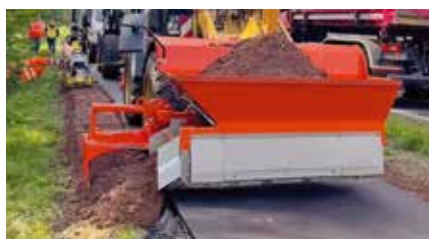
0,5 m³ Finliner – schmale Einsatzgebiete (z. B. Radwege)
