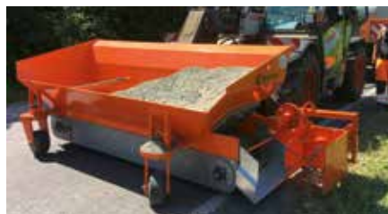
Bankettpflege (Schaufel 1,4 m³ mit Linksauswurf)
