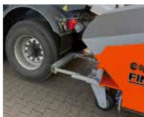
0,5 m³ Finliner – schmale Einsatzgebiete (z. B. Radwege)
