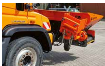
Das Bankettschild für die 1,4 m³ Schaufel wird für die Fahrt zum Einsatzort einfach hochgeklappt. Dadurch verringert sich die Gesamtbreite des Anbaugerätes und das Einsatzfahrzeug bleibt somit straßenverkehrstauglich.
